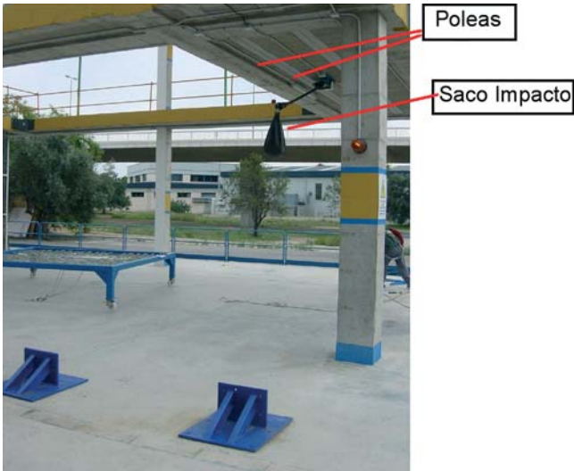
Saco de Impacto y conjunto de poleas para requisitos carga dinámica en protecciones de borde clase B
